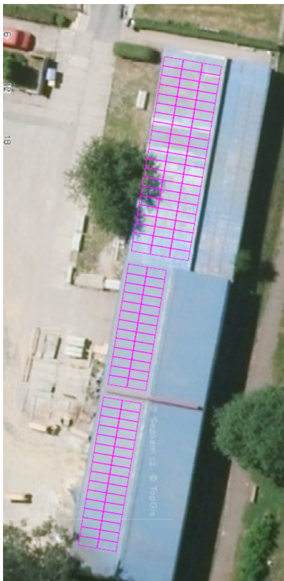
Obrázek 74: Odhad řešení FVE na budově Teplo Chodov
